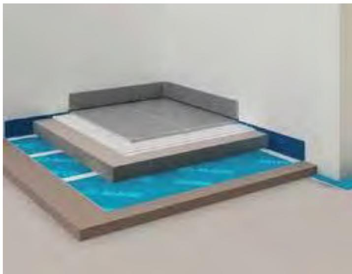
**Art. 22 – IMPERMEABILIZZAZIONI BALCONI E TERRAZZI:** Saranno realizzate con fornitura e posa in opera di uno strato di guaina bituminosa sp. mm4, saldata a fiamma sul solaio, compreso sovrapposizioni, giunte, risvolti e quant' altro necessario ad eseguire il lavoro a perfetta regola d' arte e successivo strato di NANOFLEX ARMATO o prodotto similare sul massetto lisciato, compreso risvolto a parete.
